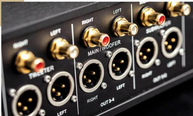
Audimax RAP-1 有标准版(只带 XLR 输入与输出)与 RAP-1S(有 RCA 输入与输出)二种型号,建议的用法是放在 CD 机与合并功放之间,或者放在前后级功放之间。背板有一个网络线端子,必须连接家里路由器才能让计算机与 RAP-1 相通。模拟输出有 Tweeter、Main/Woofe、Subwoofer 三组,这是给电子分音用的,原厂预设的是 Main/Woofe 这组输出。所有 XLR 平衡端子都是瑞士 Neutrik 顶级产品,我建议以平衡输入 / 输出连接,动态明显提升
