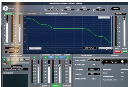
平直的曲线可以无阶段任意调节，比如 2kHz 以上高音衰减一点让小提琴更温暖有厚度，125Hz 增加一点让鼓声更饱满有力。调节时每个点升降一格是 1dB，加多减少请随意，只要透过鼠标在计算机屏幕上拉动曲线即可，而优化过的相位、脉冲响应特性并不受影响，也就是我们可以听到在正确声音基础上，自行添加调味料后的效果。万一加油添醋太过头，声音扭曲变形了，没问题，复原“参考目标曲线”即可，重新再调节直到完全满意为止。爵士、管弦乐、人声、电影等不同类型节目，也可以自订多个响应曲线，开机后默认最后一次使用的曲线，非常方便，方便到后来你会忘记它的存在
