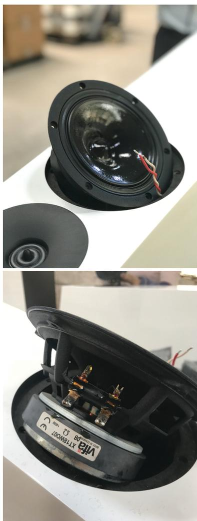
中低音采用 VIFA 顶级单元，振膜材料由特殊的纸和木纤维浆料混合制成，坚实又轻盈，具有不均匀分散特性，最大限度降低了表面共振，确保每个声音信号都能纤毫无损的再现
